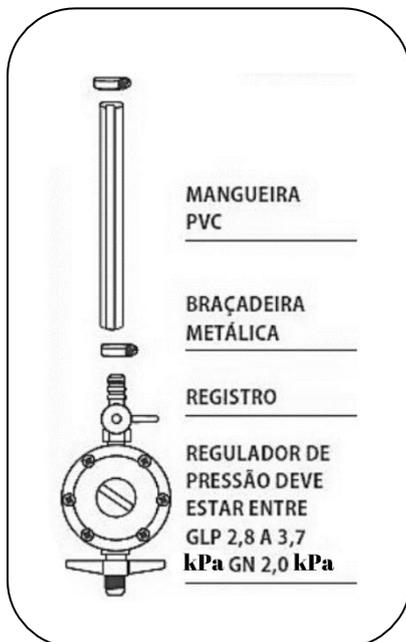
Figura 5 - Instalação GLP de botijão P13 ou P45
