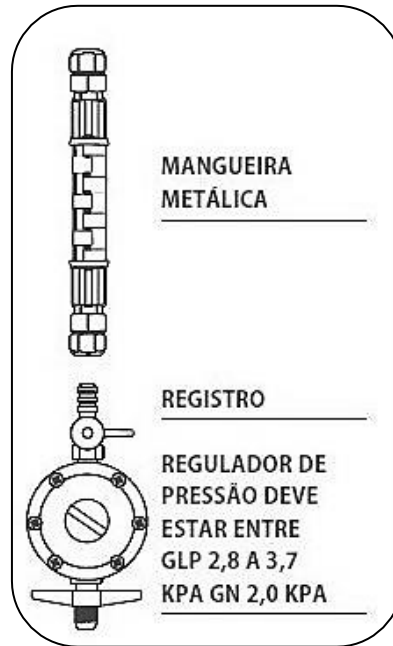
Figura 6 - Instalação GLP encanado
