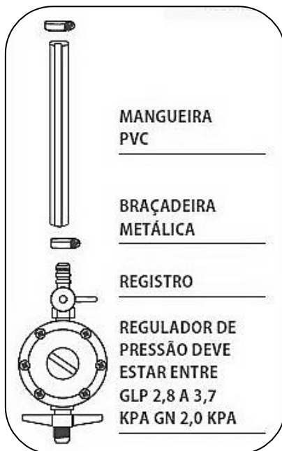
Figura 5 - Instalação GLP de botijão P13 ou P45
