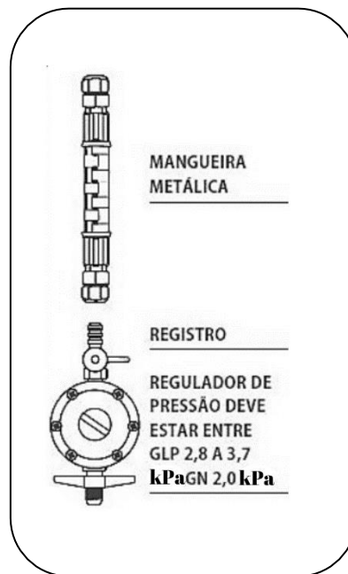
Figura 6 - Instalação GLP encanado
