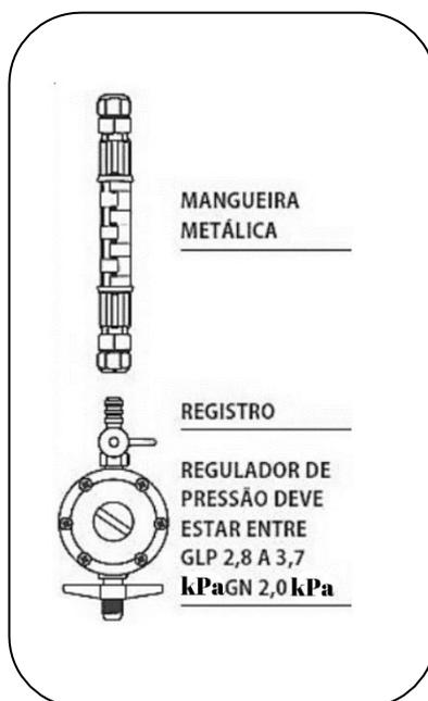
Figura 6 - Instalação GLP encanado
